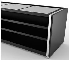
Für jeden gewünschten Stellplatz wird eine 12 mm starke Aluminiumplatte (EN AW-5083, natur E0/C6 eloxiert) in den Fachboden eingesetzt und auf 3 Spikes in Spikeschuhen aus Edelstahl 1.4305 gelagert.
