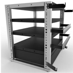
Zugentlastungsschienen aus eloxiertem Aluminium innerhalb der Installationsebene. Mit den mitgelieferten Klettkabelbindern können sie Ihre Kabel einfach und immer wieder befestigen. Die Zugentlastungsschienen können in einem Raster von 25 mm werkzeuglos umgesetzt werden.
